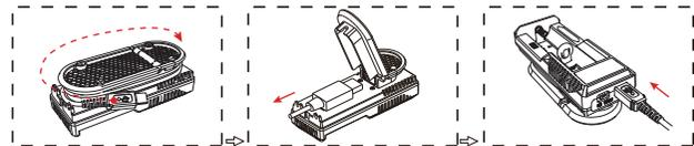
2. Установка аккумулятора: Установите аккумулятор так, как показано на рисунке. Неправильно установленный аккумулятор сделает невозможным нормальное функционирование UM10.
